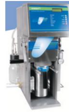
เครื่องสกัดไขมัน (FAT EXTRATOR) ใช้วิธี SOXHLET ร่วมกับ FILTER BAG 15 ตัวอย่าง รุ่น XT 10
